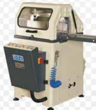
برش یک سر پلوماتیک ( برش از پایین ، تیغ اره ۴۰۰ میلیمتر ، ریل جانبی ۳ متر )
