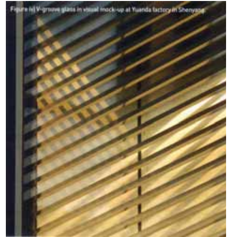
شیشه شیاردار تولید شده در کارخانه یوآندا در شنیانگ طرح این شیشه ساختگی بوده و نمونه اصلی نمی باشد
