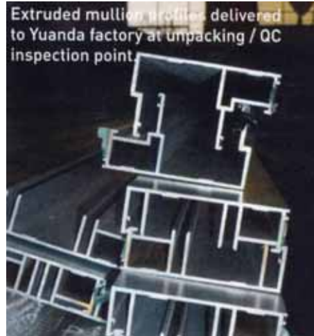
پروفیل مولیون اکستروژن شده که به کارخانه یوآندا تحویل داده شده است/ بازگشایی، بسته بندی و بازرسی
